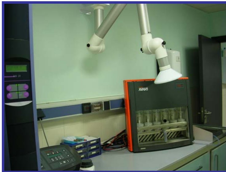
Figura 6. Sistema de extracción soxtec
